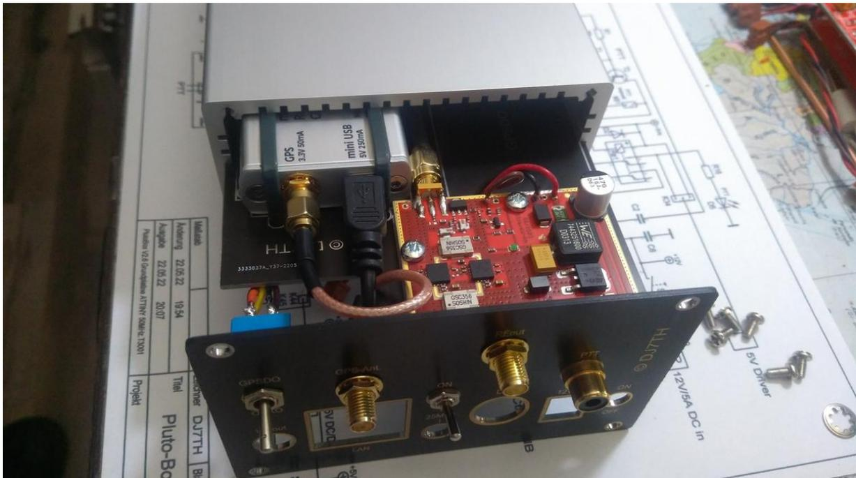
6W AMSAT-DL PA + Bodnar 100MHz GPSDO auf ein Aluminium-Board montiert
