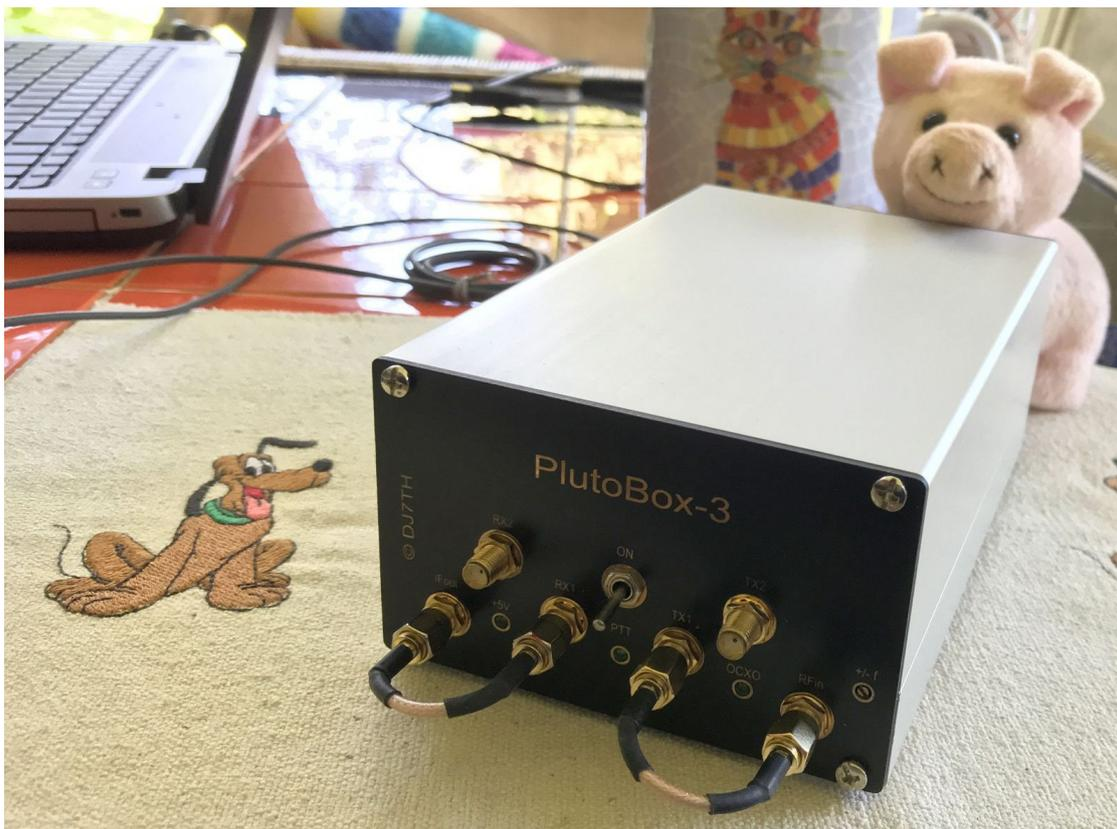
Ende Mai 2022 habe ich meine PlutoBox Version 3 in Betrieb genommen. Der komplette 2.4GHZ TRX ist in einem stabilen Aluminiumprofilgehäuse mit den Maßen 105x160x64mm von Fischer Elektronik untergebracht, bestehend aus zwei Halbschalen. Mehrere interne DC/DC-Wandler erzeugen 5 V für den Pluto, 3,3 V für den OCXO und 12 V für den LNB. Somit ist ein stabiler Betrieb des TRX mit einer externen Stromversorgung von ca. 8V bis ca. 16V ist möglich.
